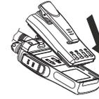
Bataryayı cihazın alt kısmındaki tırnağa oturacak şekilde tutup üst kısmı çit sesi duyuluncaya kadar cihaza doğru itiniz.
