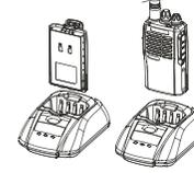
Boş Bataryayı tek veya telsize takılı olarak şarj cihazına yerleştiriniz, akıllı şarj cihazınız önce bataryanın durumunu ölçmek için kısa bir süre bekleyecek, kırmızı şarj ışığı yanacak ve şarj işlemi başlayacaktır, şarj işlemi tamamlandığında yeşil uyarı ışığı yanacaktır. Bataryalar fabrikada şarj edilmemektedir, ilk kullanımdan önce muhakkak kesintisiz olarak şarj edilmelidir.
