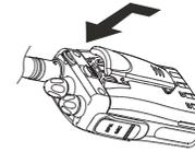
Bataryayı çıkarmak için cihaz kemer askısının orada bulunan kilidi basılı tutup bu esnada bataryayı geriye doğru ok yönünün tersine çekiniz.
